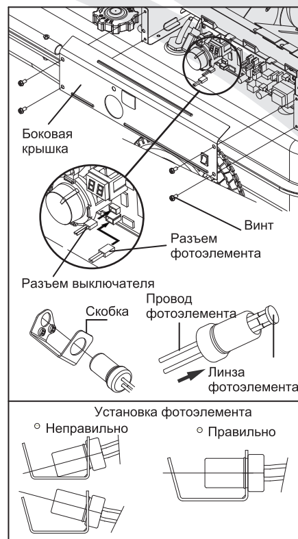
Рис. 13 Замена фотоэлемента
